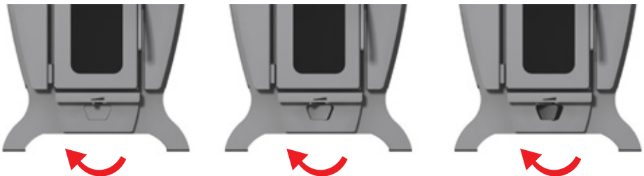
Рисунок - 1. Регулировка подачи воздуха верхним и нижним микрошиберами
